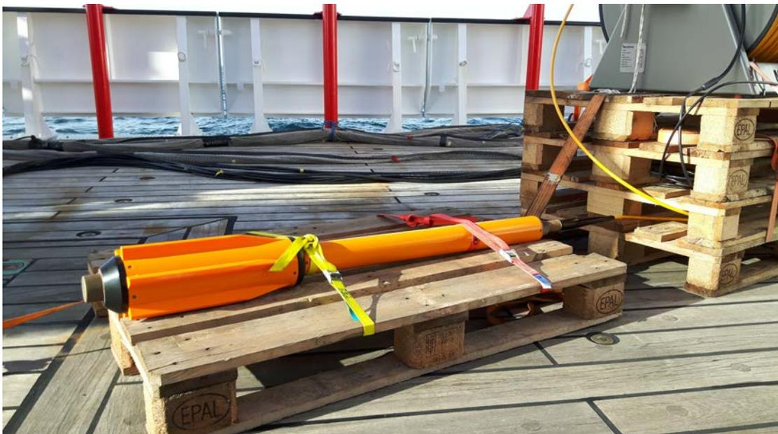
*Das geschleppte Magnetometer während einer "Ruhepause" an Deck.
