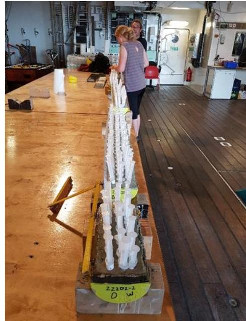
Link: Zwei Aufnahmen vom Videoprofil GeoB22208-1, das bei 152° 07.62' E, 23°18.738' S startete und das Paläoriff/küstenlinie zwischen 90 m und 120 m Wassertiefe überquerte. Rechts: Beprobung des Schwerelots GeoB22202-2 an Bord der SONNE in 4 cm Intervallen mit drei Spritzenserien.
