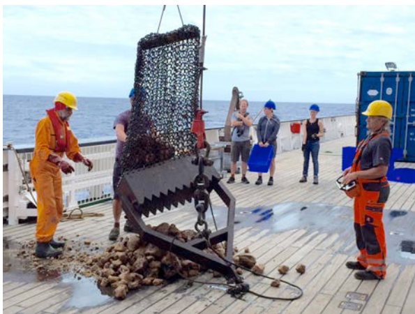
Eine fast völlig mit Bimsstein gefüllte Dredge wird an Deck geleert. (Kaj Hoernle)
