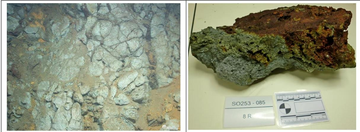
sehr selten ist. Die Fotos zeigen auf der linken Seite das am Meeresboden anstehende Stockwerk-Erz, das sich in den Fluidaufstiegskanälen im Untergrundgestein gebildet hat. Das rechte Foto zeigt eine Probe, die mit dem Manipulator-Arm des ROV aus diesem Stockwerk-Erzkörper herausgezogen worden war.
