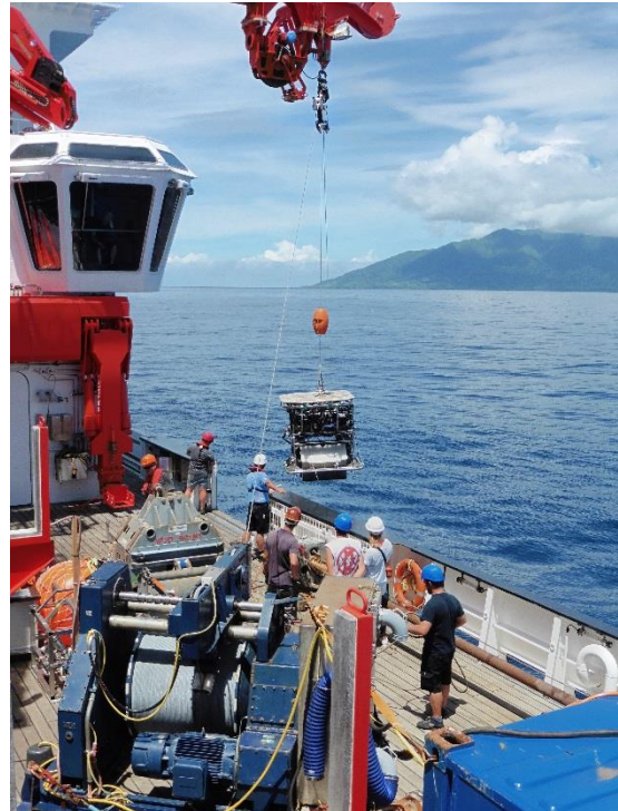
Abbildung 1: Klarmachen von HyBis vor Sakar Island um das OBS zu bergen, das sich an seinem Schwimmseil verfangen hatte. Foto: Oliver Meyer.
