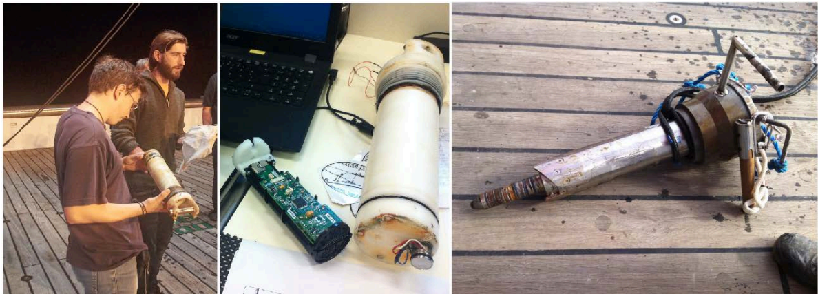
Links und Mitte: Der „MeBoPlug“, ein kleines Bohrlochobservatorium, kam mit ROV PHOCA sicher an Deck. Auf der Platine befinden sich 720 Mbyte an Daten des Schlammvulkans, die auf dem Laptop gesichert werden. Rechts: Der MeBoCORK-A an Decke, nachdem er aus dem Bohrgestänge gelöst wurde.
