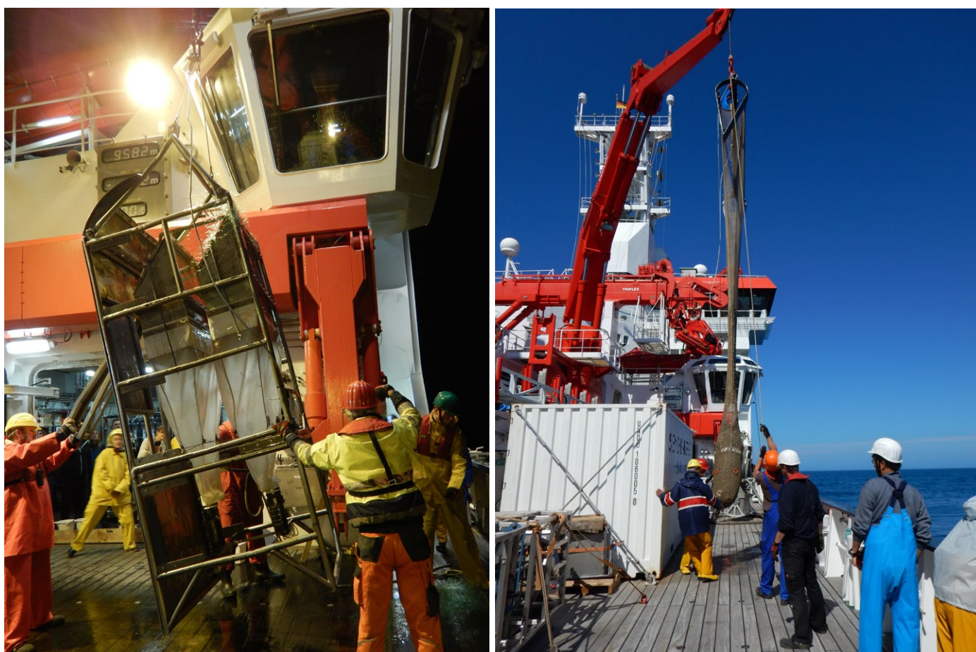
Abbildung 1: Der Epibenthoschlitten (EBS) „META“ (links) und das Agassiz Trawl (AGT, rechts) werden von der tiefsten Probenahmestation dieser Expedition zurück auf das Arbeitsdeck des FS Sonne gebracht. In den feinmaschigen Netzen des EBS und den groberen des AGT befinden sich Organismen aus 9581 m Tiefe. Diese Station war die tiefste, die je mit einem EBS durchgeführt wurde. (c) Angelika Brandt
