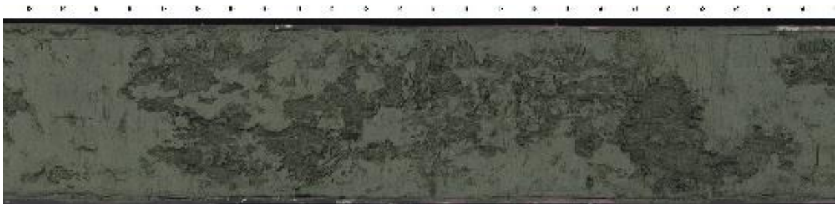
Abb.1: Ein Scan des Sedimentkernes GeoB20803-2 zeigt in einer Tiefe ca. 79 Metern von deutliche Störungen ausgelöst durch freigesetzte Gase.
