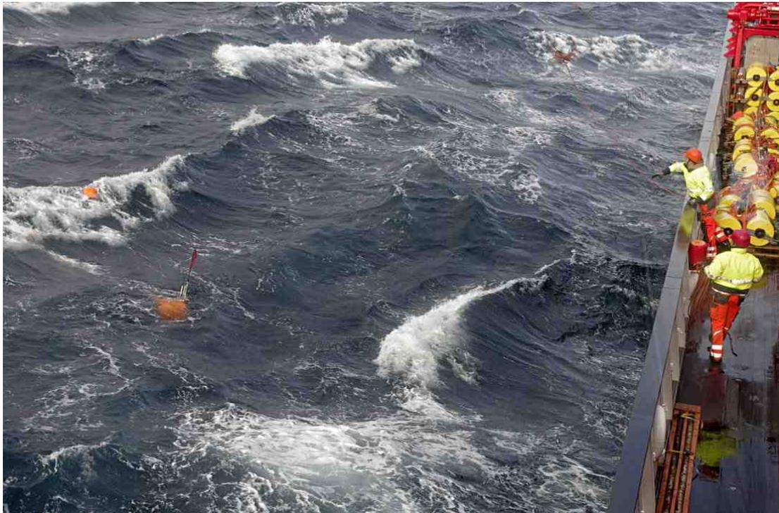
Das Bergen der OBSen bei stürmischer See ist eine Herausforderung für die Besatzung auf der Brücke und auf dem Arbeitsdeck. In diesem Fall wurde mit dem Enterhaken die Schwimmleine des Geräts mit nur einem Wurf erwischt (Foto: T.N. Gades).
