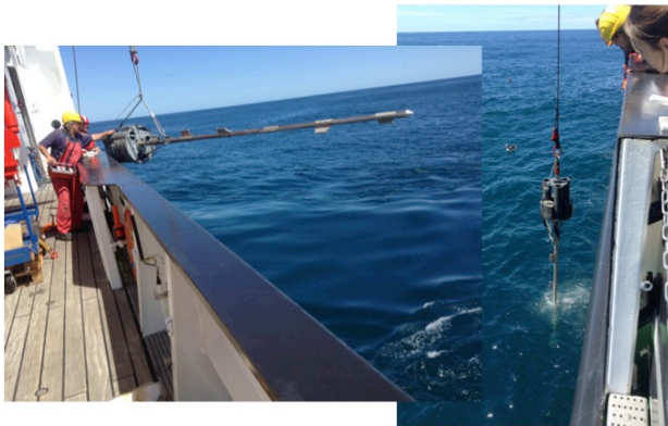
Die Wärmelanze, bespickt mit hochempfindlichen Temperatursensoren, wird auf den Weg zum Meeresboden geschickt, um die Temperaturverteilung im Sediment zu messen.
