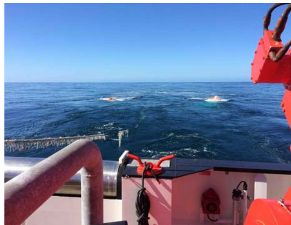
SONNE schleppt den Hydrophon-Streamer und die Luftpulser für seismische Profilmessungen (Foto: B. Davy).
