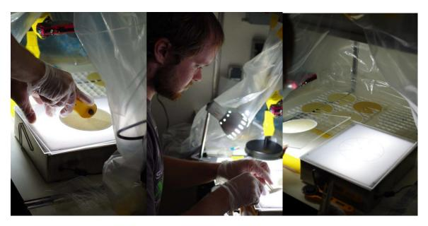
Bearbeitung und Prozessierung der Filter aus den *in situ* Pumpen.
