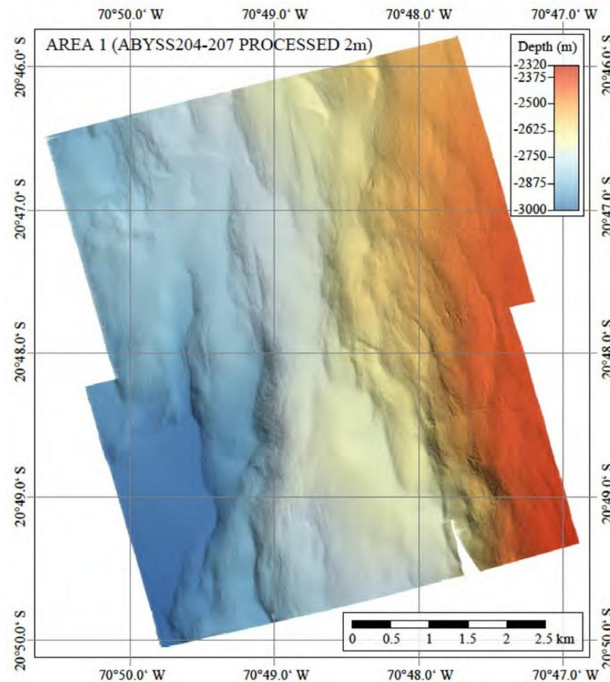
*AUV Kartierung des ersten Einsatzgebietes am mittleren Kontinentalhang vor Nordchile (2 m Auflösung). Insgesamt 8 GeoSEA Tripoden werden als Netzwerk in diesem Gebiet abgesetzt.*
