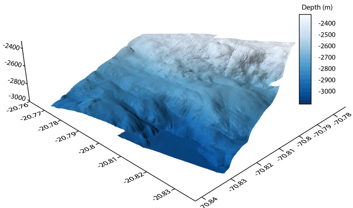
Abbildung 1: Ansicht von SW auf das aus AUV-Kartierungen berechnete digitale Höhenmodell des Kartiergebietes 1 mit ca. 3 m Auflösung. Beleuchtung des Reliefs von SE.
