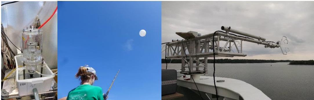
Abb. 3. Von links: „underway“-Seewasser Equilibrator, Radiosonde an einer Angel, Mast für Eddy-covariance-Messungen. (C. Marandino, T. Tanhua)
