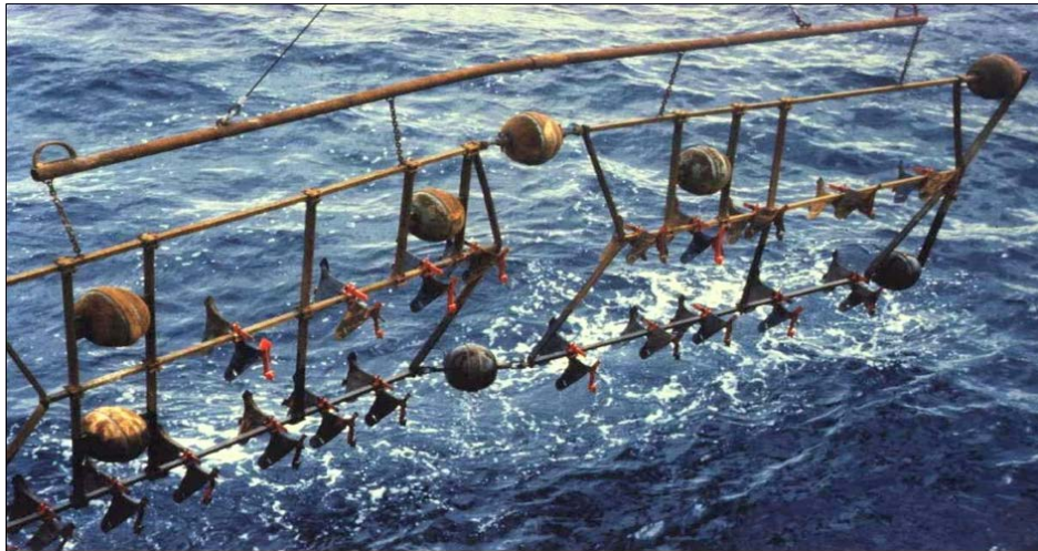
Abb. 3 Tiefsee-Pflug oder Pflugegge, womit 1989 die mechanischen Störungen am Meeresboden erzeugt wurden. Dabei sind keine Mn-Knollen vom Meeresboden entfernt, sondern lediglich untergepfügt worden.
