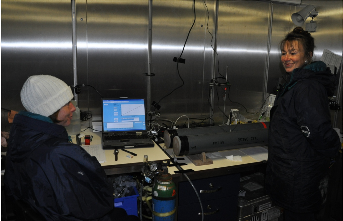
Ingrid Dohrmann und Sabine Kasten (AWI Bremerhaven) führen Messungen der Sauerstoffkonzentrationen in Sedimentkernen durch. Die Sedimente müssen vor der Messung auf 4°C gekühlt werden, was in etwa der Umgebungstemperatur am Meeresboden entspricht. (Foto: I. Preuss)
