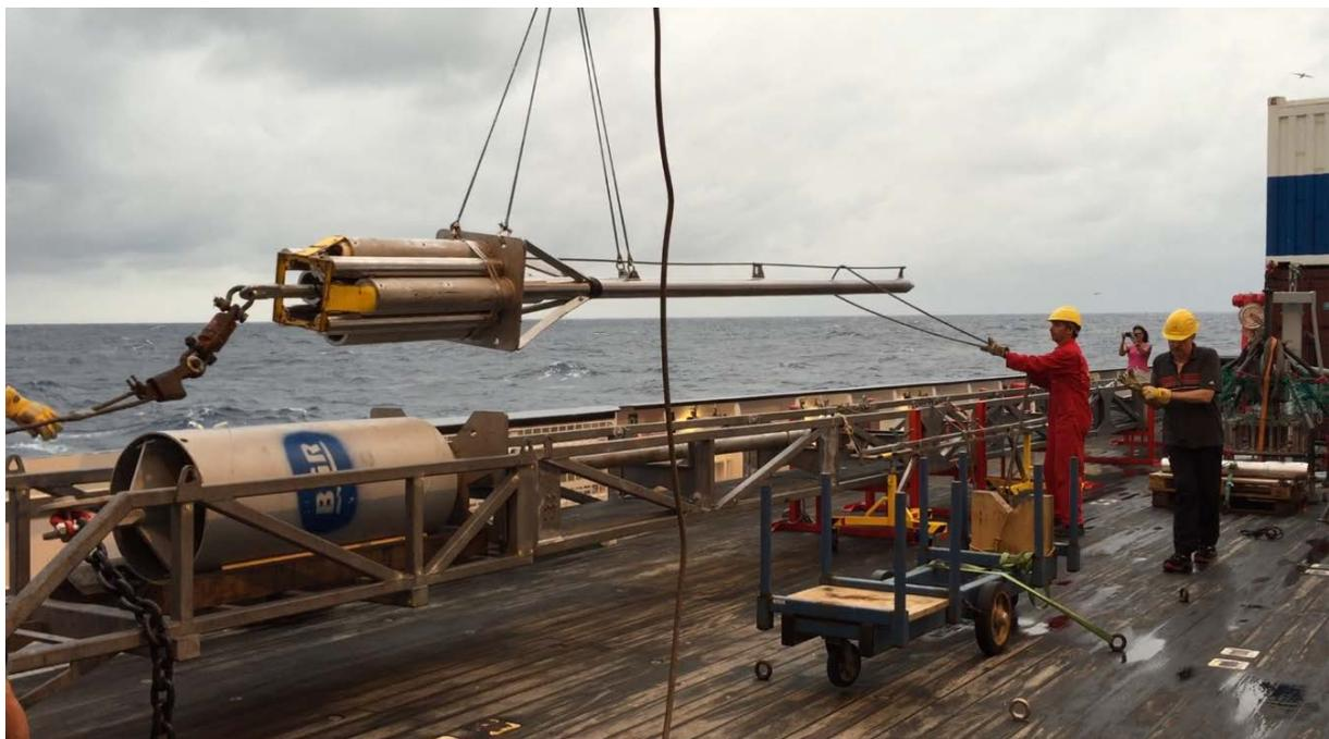
Aussetzen der Wärmestromsonde auf FS Sonne (Foto: R. Singh)
