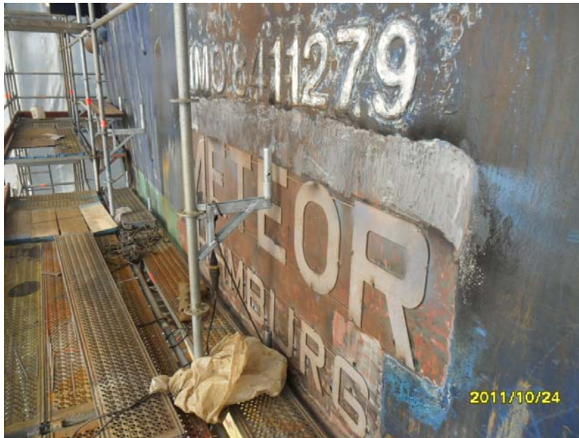
Anbringen des Schiffnamens und des Heimathafens am Heckspiegel
