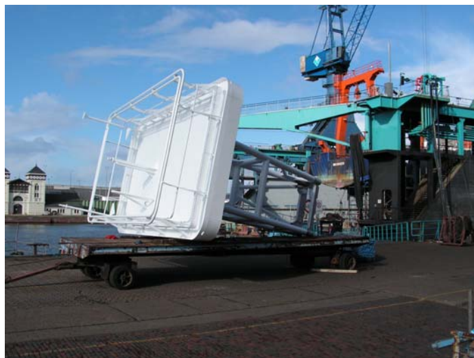
Konservierung der neuen oberen Mastplattform
