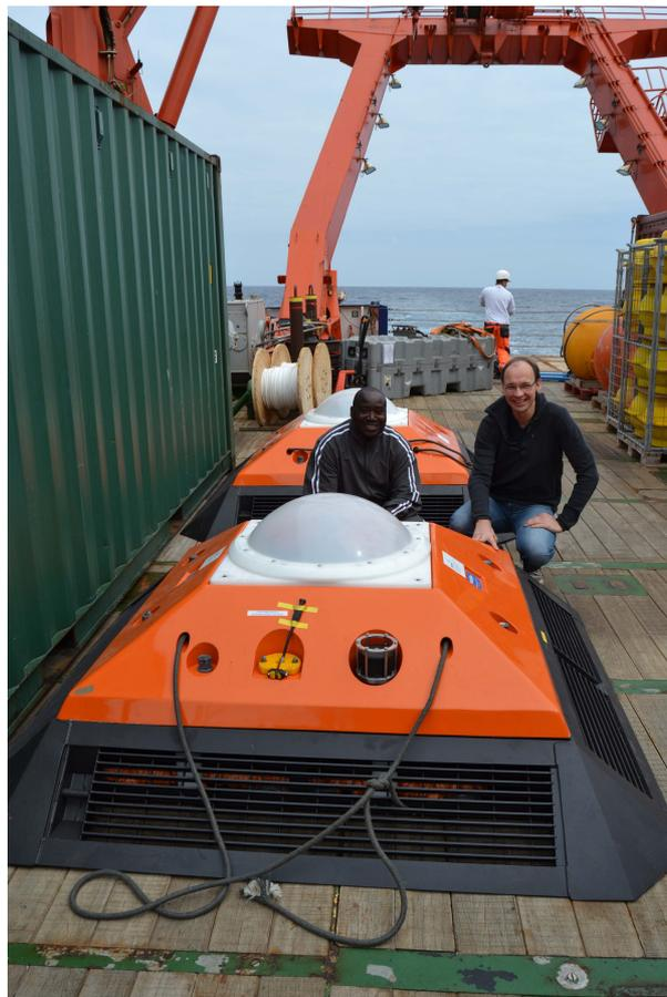
**Abb. 1:** Zwei Bodenschilde mit eingebauten akustischen Strömungsmessern an Deck der Meteor kurz vor der Auslegung am Schelf vor Angola. Die Instrumente wurden auf 200 m und 500 m Wassertiefe abgesetzt und werden dort für etwa 1.5 Jahre Strömungsdaten aufzeichnen.
