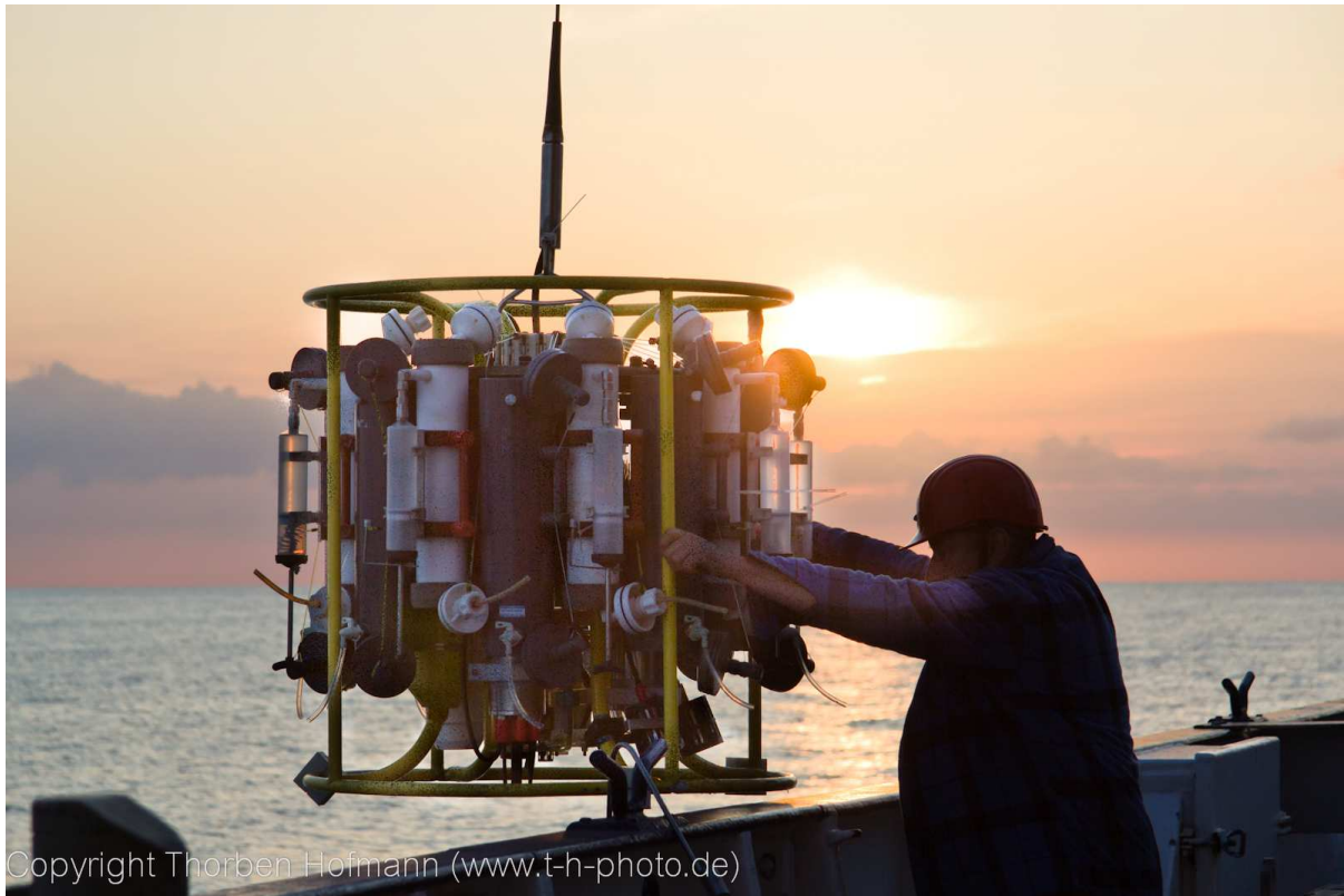
Abbildung 2: Aussetzen des Automatic Fixation in situ Samplers (AFIS) an CTD-Rosette.
