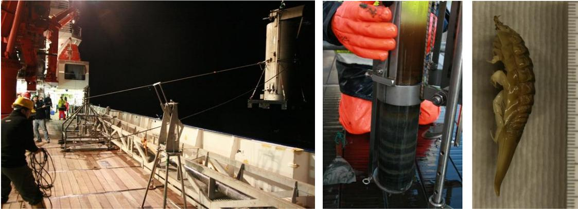
**Links: Einsatz des Großwasserschöpfers auf einer der ATKiM-Stationen, mit dem 400 Liter Oberflächenwasser zur Gestaltung der mikrobiologischen Bordexperimente entnommen wird. Mitte: Erfolgreicher Multicorer-Einsatz in der Bottenwiek; die bräunliche Oberfläche des Sediments ist durch hier häufig vorkommende, mehrere cm-große endemische Assel-Arten (rechts) durchwühlt..**
