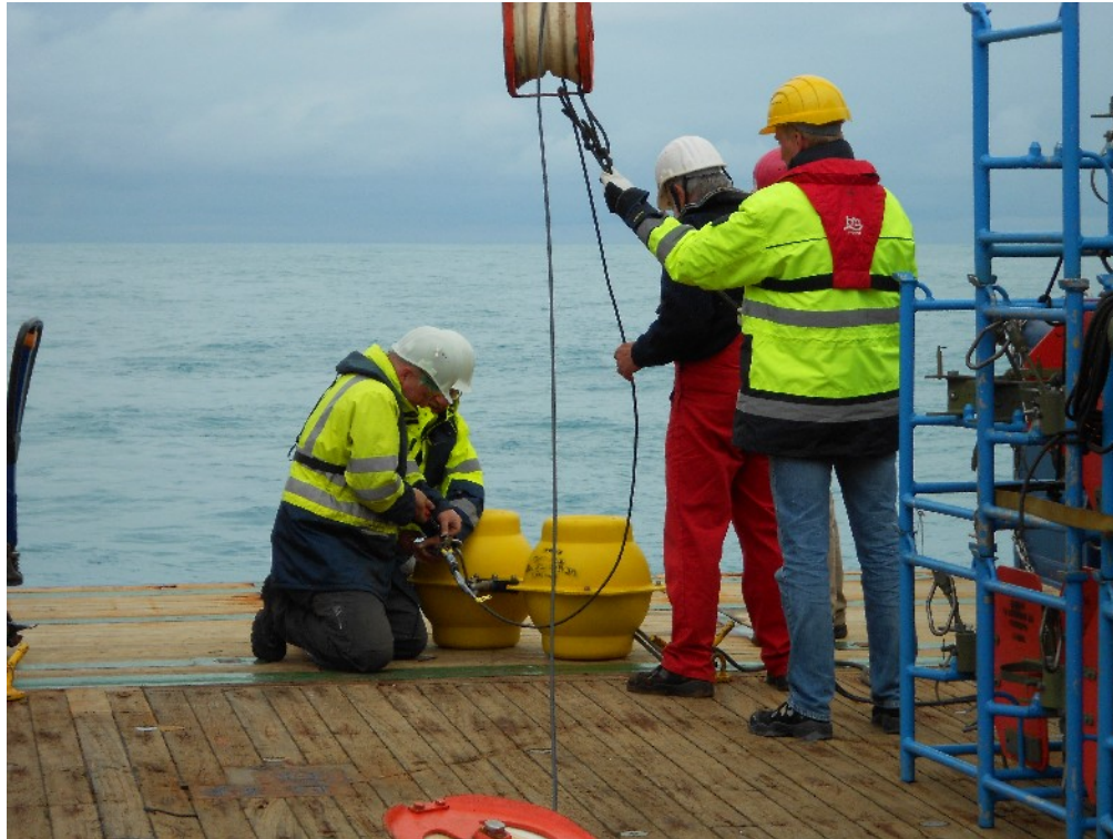
Die Auftriebskörper der Verankerung FBZ-3 werden für die Auslegung vorbereitet.
