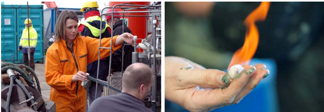
Abbildung 2: Beprobung des Minicorers (links); Sich zersetzendes Gashydrat, das soviel Methan freigibt, dass eine Flamme genährt wird (Brenndes Eis; rechts; V. Diekamp, MARUM Bremen)
