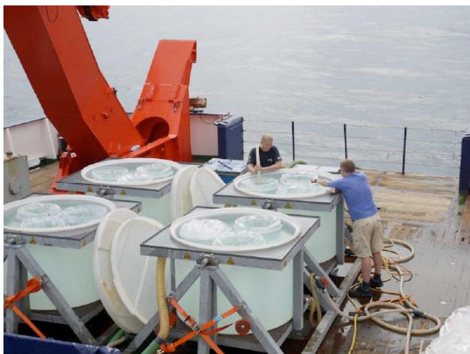
*Mesokosmen auf dem Heck des Schiffes werden mit Oberflächenwasser befüllt. Jeder der kardanisch aufgehängten Behälter kann drei 150l Experimente aufnehmen.*
