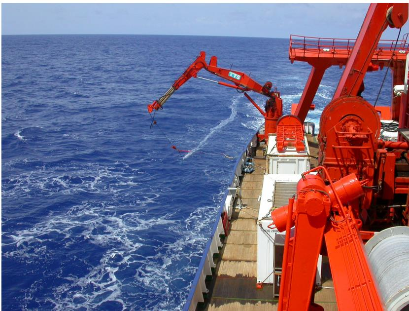
Abb. 1: Der Schleppfisch des IFM-GEOMAR im Einsatz an einem Kran der Meteor..
