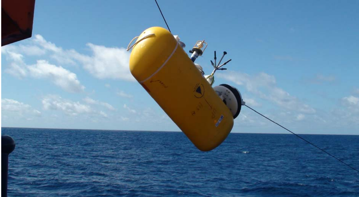
Abb. 1: Ein Profiler verlässt das Schiff und soll hier am Äquator Wassermasseneigenschaften und Strömungen zwischen 3500m und 1000m Tiefe vermessen.
