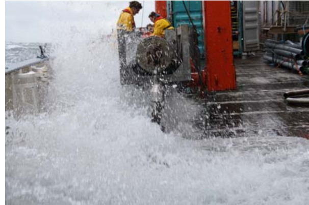
Abb. 1: Arbeiten am Absatzgestell des Schwerelots bei schwerer See
