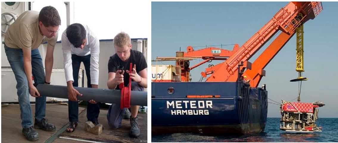
Abbildung 3: Zerlegung des gerade geborgenen Schwerelotkernes in einzelne Segmente (links). ROV QUEST geht von FS METEOR zu Wasser (rechts). Fotos: V. Diekamp (MARUM)
