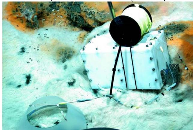
**Abbildung 3:** Das nach vorne schauende Sonar von ROV QUEST zeigt den Piloten und Wissenschaftlern die genaue Lage, aber auch die Ausdehnung der Muschelfelder am Meeresboden (links). Der mit ROV QUEST auf einer Bakterienmatte abgesetzte Osmo-Probennehmer, der über mehrere Tage die geochemische Veränderungen direkt über der Bakterienmatte registriert (rechts). Beachte die Blasenaustritte in der linken Bildhälfte. ROV QUEST Photo (MARUM).
