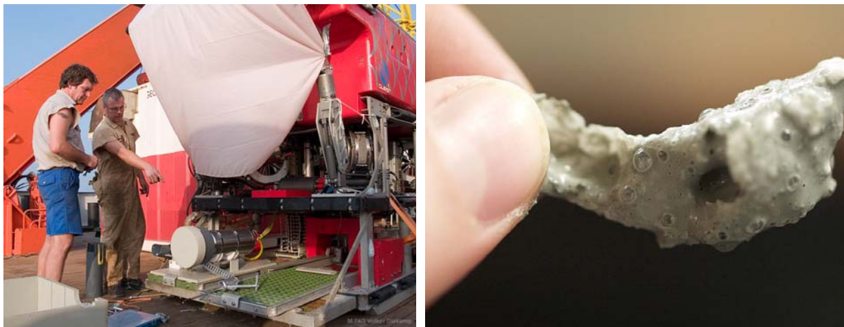
Abbildung 2: Vorbereitung von ROV QUEST auf dem Arbeitsdeck von FS METEOR. In der Tageshitze müssen immer wieder Teile des Roboters vor der unmittelbaren Sonneneinstrahlung geschützt werden (links). Gashydratstück aus dem ersten Schwerlotkern der Reise. Methanblasen und ein überdeckender Wasserfilm aus der Zersetzung des Gashydrates sind deutlich zu sehen (rechts; Bilder V. Diekamp, MARUM).
