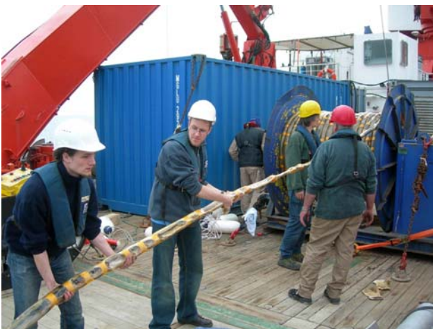
Abbildung 1: Neben der Sediment- und Gashydratbeprobung sind geophysikalische Untersuchungsmethoden während des 2. Fahrtabschnittes der M72/3 von besonderer Bedeutung. Aussetzen des 600m langen Streamers für mehrkanalseismische Messungen (links) und Sidescan Sonar DTS mit Depressor im Vordergrund kurz vor dem Aussetzen auf dem Arbeitsdeck achtern.
