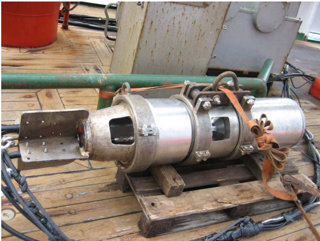
Abb 2: 32-Liter Luftpulser. Zwei dieser Kanonen wurden auf M69/2 als seismische Quelle verwendet.
