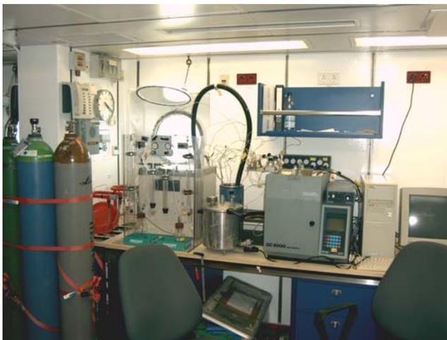
*Ein Blick in eines der Chemielabore, in dem bereits ein Gaschromatograph aufgebaut ist*
