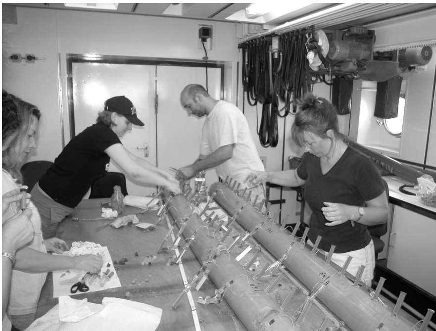
Beprobung eines Sedimentkernes im Geologielabor von FS Meteor .
