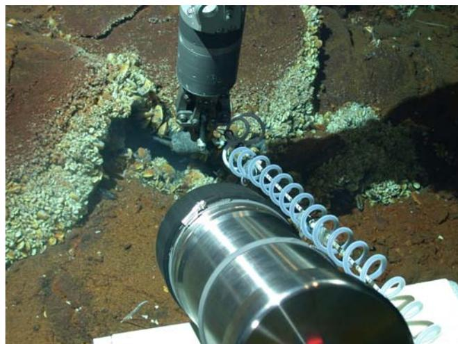
Fluidbeprobung mit dem MARUM QUEST ROV an einer hydrothermalen Quelle bei 9°33'S am Mittelatlantischen Rücken
