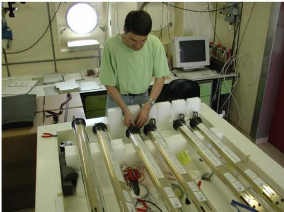
Zunächst wird die Funktion der RAFOS-Floats im Labor getestet, dann werden sie gestartet und schließlich mit einem Plastikrohr am Heck von METEOR ausgesetzt.
