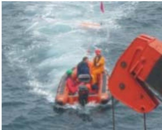
*Bild1: Bergen des „Walzen“-OBS's. Das Gerät wurde erfolgreich mit einem Draht „gedredged“ und mit einem Boot geborgen.*
