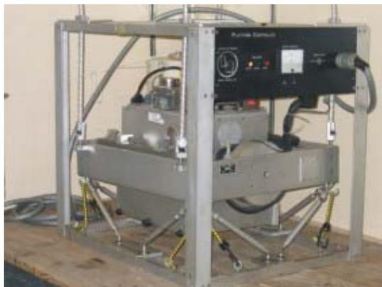
*Bild 3: Foto des in Cork installierten und gut funktionierenden Gravimeters*
