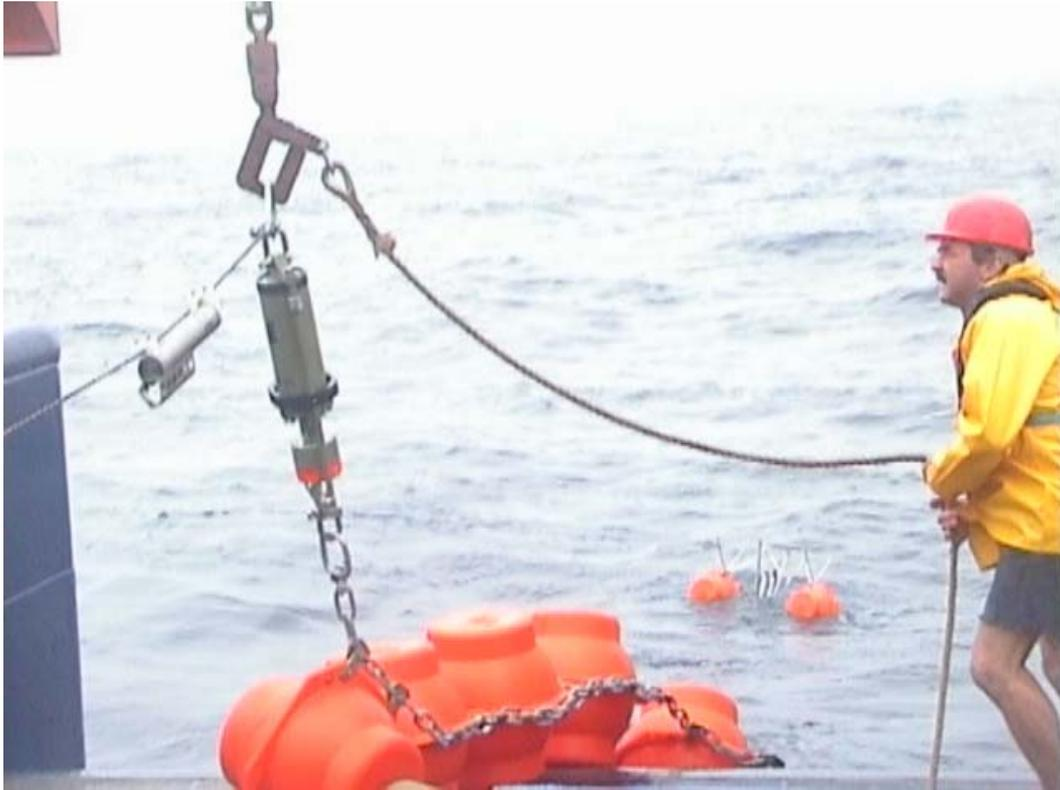
Beginn der B2 Verankerung. Im Wasser ist die Kopfboje mit Sender und Blitzlicht zu sehen. Da die Kopfboje in ca 3600m Tiefe hängen wird, konnte nicht die sonst übliche Konstruktion benutzt werden. An der Heckslippe sind die Auftriebskugeln zu sehen, rechts vom Haken kann man den akustischen Strömungsmesser erkennen, der T-S Sensor ist am Draht angeklemt.
