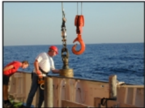
Einsatz eines Schwerdieses zur Beprobung einer plio-pleistozänen Karbonatplattform vor dem Cabo de Gata.
