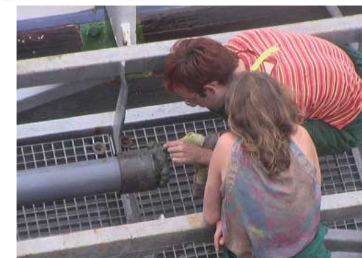
Am Kernfänger eines 3m Schwerelotes: nur wenige Zentimeter des bindigen alten Sediments konnten an Deck gebracht werden.
