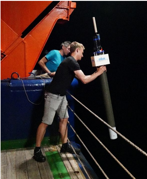
Abb. 2: Auslegung eines Argo Driftkörpers auf dem Äquator bei 7.5°W (Photo P. Henning).
