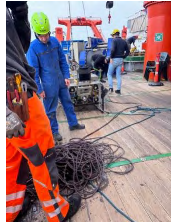
Abbildung 4: Videoschlitten MOMO auf dem Arbeitsdeck der METEOR. Im Vordergrund ist die Leine zu erkennen, in der sich MOMO in einer Wassertiefe von über 300 m verfangen hatte.
