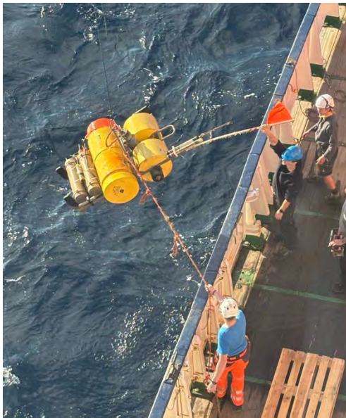
Abbildung 3: Bergung eines Ozeanbodenseismometers (OBS). Das Gerät wurde im Januar 2025 auf der Expedition MSM132 am Meeresboden installiert, um Erdbebenwellen zu registrieren. OBS arbeiten autonom mit eigener Energieversorgung und werden mittels eines akustischen Signals geborgen. Die insgesamt acht OBS haben die seismische Krise um Santorini im Jan-Feb 2025 aufgezeichnet und liefern wertvolle Daten, um die Geschehnisse gezielt einordnen zu können. Zusätzlich waren an einigen Geräten Druck- und Temperatursensoren angebracht.
