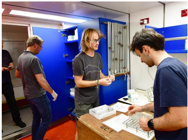
Abbildung 2: Probenbearbeitung im Chemielabor der METEOR, Nach jeder CTD-Station werden die Proben der 24 Wasserschöpfer auf ihren Methangehalt hin analysiert (© Elmar Schreiber).
