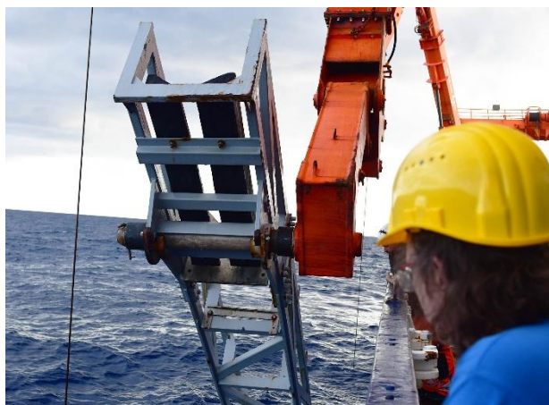
Abbildung 4: Schwerelot-Beprobung mit dem Kernabsatzgestell, das vom Arbeitsdeck über das Schanzkleid von FS METEOR gehoben wird (© Elmar Schreiber).
