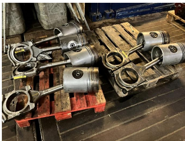
Abbildung 2: Ausgebaute Kolben des in Reparatur befindlichen Dieselgenerators, von denen insgesamt 4 Maschinen das Herzstück des Schiffes bilden (© G. Bohrmann).
