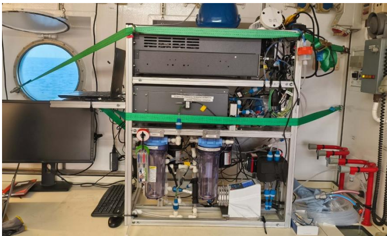
Das Unterwegsmesssystem für die Bestimmung von Spurengasen (Foto: Chaoyang Xue).
