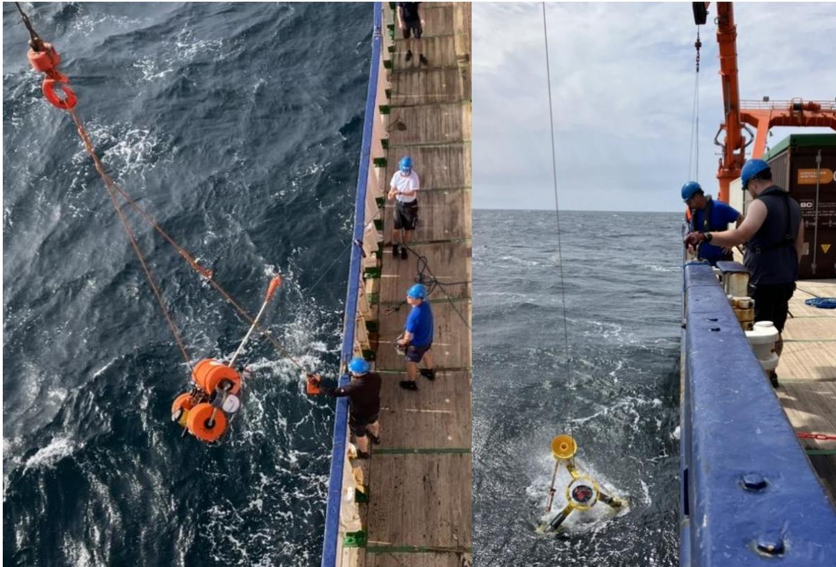
**Abb. 2:** Bergung des Landers, ausgestattet mit einem akustischen Doppler-Strömungsprofilierer (ADCP) und einem SUNA-Nitratsensor (links), sowie des Dreibeins mit einem ADCP. Die Moorings wurden in Tiefen von 100 m und 50 m eingesetzt, um interne Wellen zu erfassen, die in Richtung Küste propagieren (Fotos: Peter Brandt).
